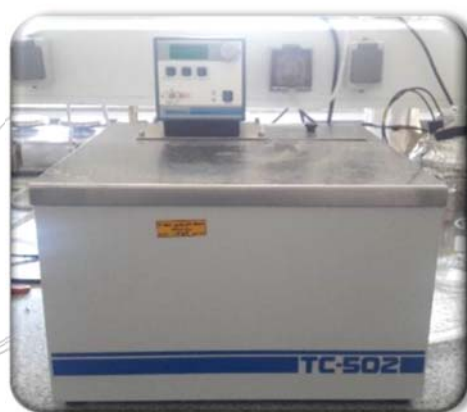
نام دستگاه: سیرکولاتور Bath Circulator آزمایشگاه: شیمی تحقیقاتی تجزیه دستگاهی کارخانه سازنده: Brookfield مدل: TC - 502 کاربرد: کنترل دما
