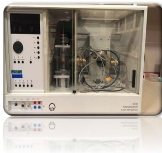
نام دستگاه: پراش اشعه X X Ray Diffraction آزمایشگاه: فیزیک کشور سازنده: Leybold آلمان مدل: x-ray-55481 کاربرد: بلور شناسی و فلورسانسی
