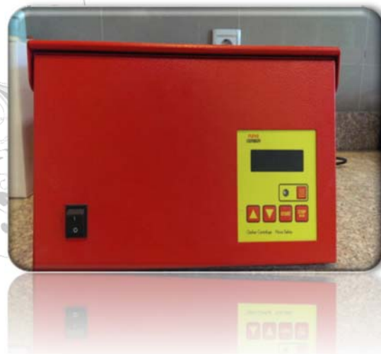
نام دستگاه: سانتریفیوژ Centrifuge آزمایشگاه: کشاورزی کارخانه سازنده: Gerber آلمان مدل: gerber کاربرد: استخراج محلول
