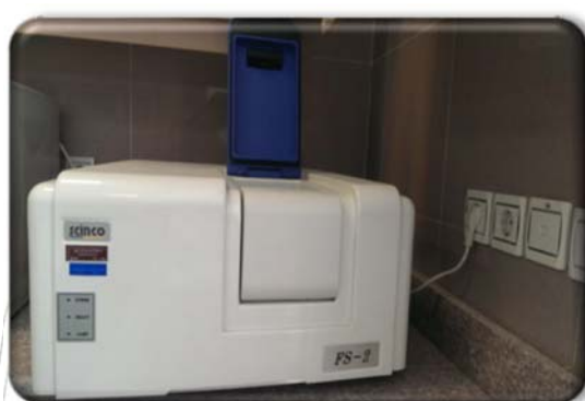
نام دستگاه: طیف سنج مرئی فرابنفش دو پرتوی UV-Visible spectrophotometry (UV/VIS) آزمایشگاه: زیست شناسی کشور سازنده: Scinco کره مدل: FS-2 کاربرد: طیف سنجی
