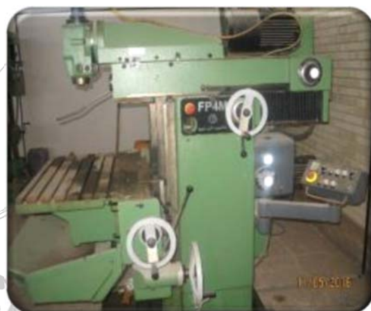
نام دستگاه: فرز کارگاه: تراشکاری و ریخته گری کارخانه سازنده: ماشین سازی تبریز مدل: MS32B کاربرد: تراش سطوح مختلف فلزات
