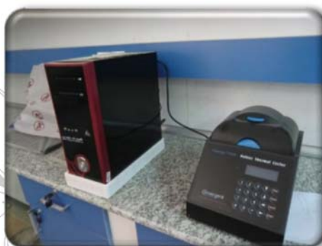
نام دستگاه: واکنش زنجیره‌ای پلیمرز (PCR کامور جت) Polymerase Chain Reaction (PCR) آزمایشگاه: ژنتیک کارخانه سازنده: PQLAB آلمان مدل: 3GPLAM CYCLE(96 TEST) کاربرد: برای تکثیر ژن
